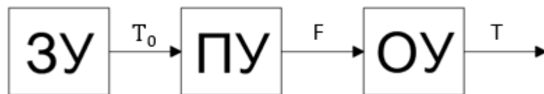
Рисунок 4.2 – Функциональная схема контура программного управления температурой в камере сгорания
