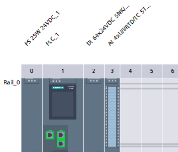
Рисунок 5.2 – Конфигурация контроллера Siemens
