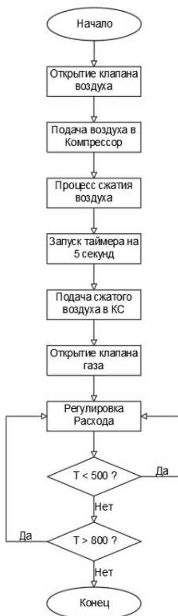
Рисунок 5.1 – Блок-схема алгоритма управления температурным режимом газов в камере сгорания
